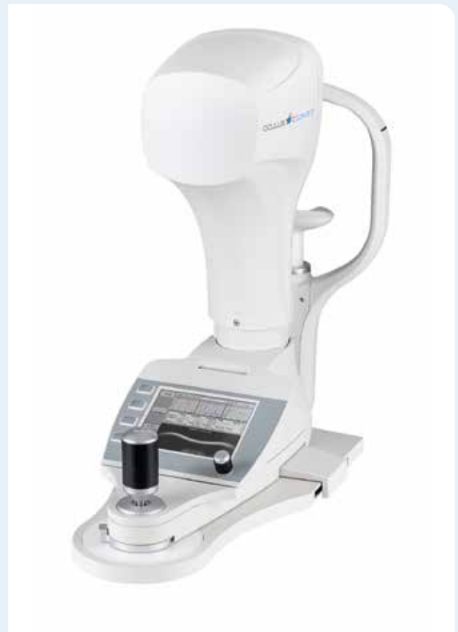
» Das OCULUS Corvis® ST, ein Non-Contact-Tonometer mit Ultra-High-speed-Kamera, zeigt Reaktion der Hornhaut auf Luftimpuls in einer kurzen Filmsequenz mit mehr als 4 000 Bildern pro Sekunde. Quelle: © OCULUS Optikgeräte GmbH
