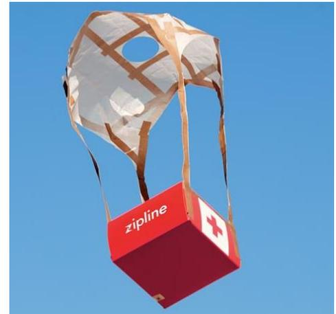
Abbildung 19 Fallschirm mit einer Medikamentenlieferung, der von einer Drohne abgeworfen wurde
